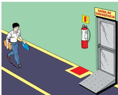
As portas devem ter, no mínimo, 0,90m de largura e estar localizadas a cada 30m da parede. Devem ser equipadas com barra de pânico, sempre do lado de fora (ABNT-NBR 9077), para facilitar a abertura.
